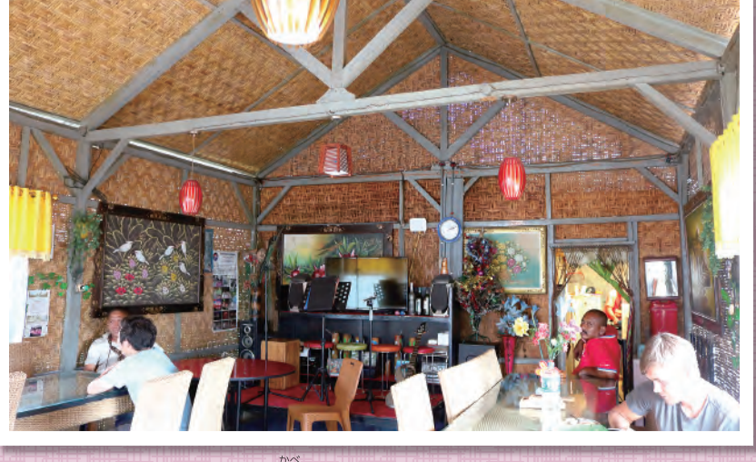
⑧暑い気候に適応した建物。壁は竹を編んでつくられており、風通しがとてもよい。
